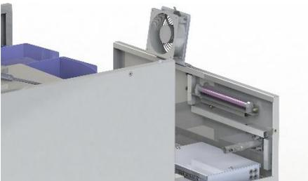
**6. Frontklappe und Deckel schließen und Befestigungsschrauben wieder eindrehen und festziehen**
