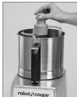
3) Das Messer auf die Antriebswelle stecken und bis zum Boden der Kutterschüssel durchdrücken. Dabei kontrollieren, daß das Messer am Schüsselboden richtig positioniert ist, indem Sie es in der Kutterschüssel drehen.
