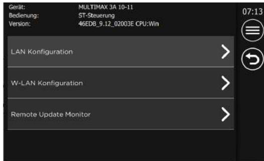
Abb. 84: Bildschirm zur *Netzwerkkonfiguration (LAN und W-LAN)*
