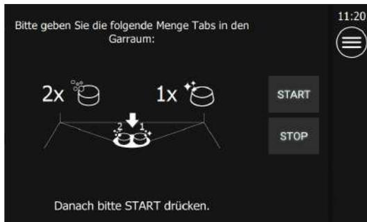
Abb. 48: Bildschirme Anzahl und Positionierung Cleaner-/ Finisher-Tabs
