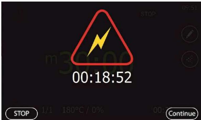
Abb. 6: Bildschirm nach unerwartetem Abschalten (z. B. Stromausfall)
