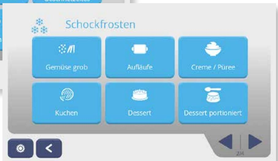
❄ Im Menüpunkt »Schnellkühlen« bzw. »Schockfrostern« wird die entsprechende Speise gewählt. Die Programme sind ab Werk einsatzfähig, Arbeitstemperatur, Temperaturschritte und Lüfter-Geschwindigkeiten sind optimal auf die jeweilige Speise angepasst. Der Kunde hat die Möglichkeit, jedes Programm ganz individuell zu modifizieren und weitere selbst geschriebene Programme hinzuzufügen.
