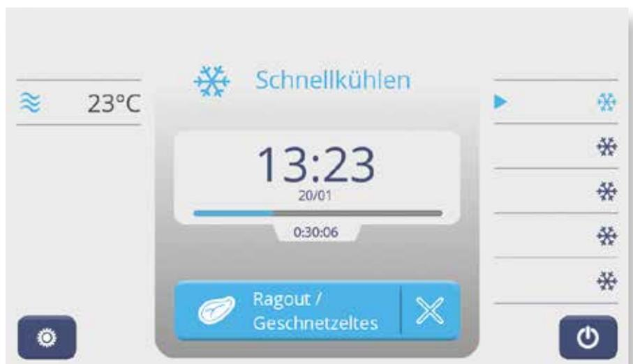
❄ Zum laufenden Programm, hier »Schnellkühlen«, werden nützliche Informationen angezeigt, wie z. B. die errechnete Endzeit des aktuell laufenden Zyklus, die abgelaufene Zeit, Arbeits- und Kerntemperatur.
