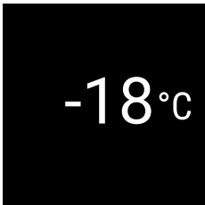
Fig. 56 Status-Anzeige mit Soll-Temperatur Die Status-Anzeige zeigt die Soll-Temperatur an und ist die Ausgangsanzeige. Von dort aus erfolgt die Navigation zu den Funktionen und Einstellungen. (siehe 5.2 Navigation) Die Status-Anzeige kann unterschiedliche Anzeigesymbole darstellen.
