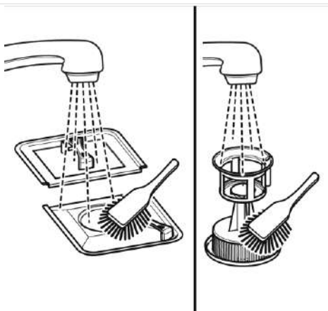
10. Tankabdecksiebe und Filter reinigen.
