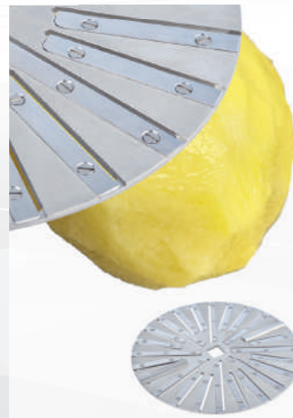
Messerschnittschältscheibe Glatte Oberfläche – wie handgeschält. Erhöhter Schälabfall, geringste Rötung, kürzere Schälzeit.
