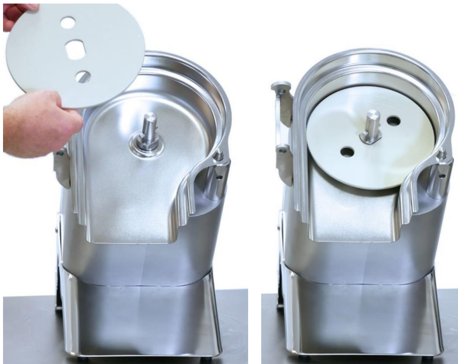
Abb. 8: Auswerferscheibe auf die Antriebswelle aufgesetzt
