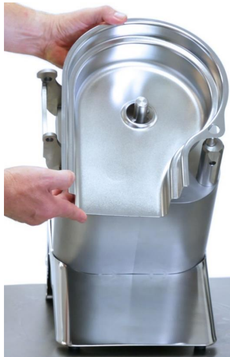
Abb. 7: Schale auf die Antriebseinheit aufstecken
