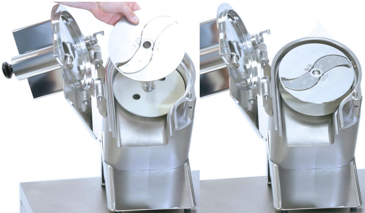
Abb. 11: Scheibe so aufsetzen, dass Mitnehmerstift in Bajonett-Verschluss eingreifen
