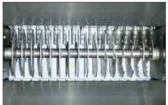
Mahlwerk des Crushermoduls aus solidem Edelstahl.
