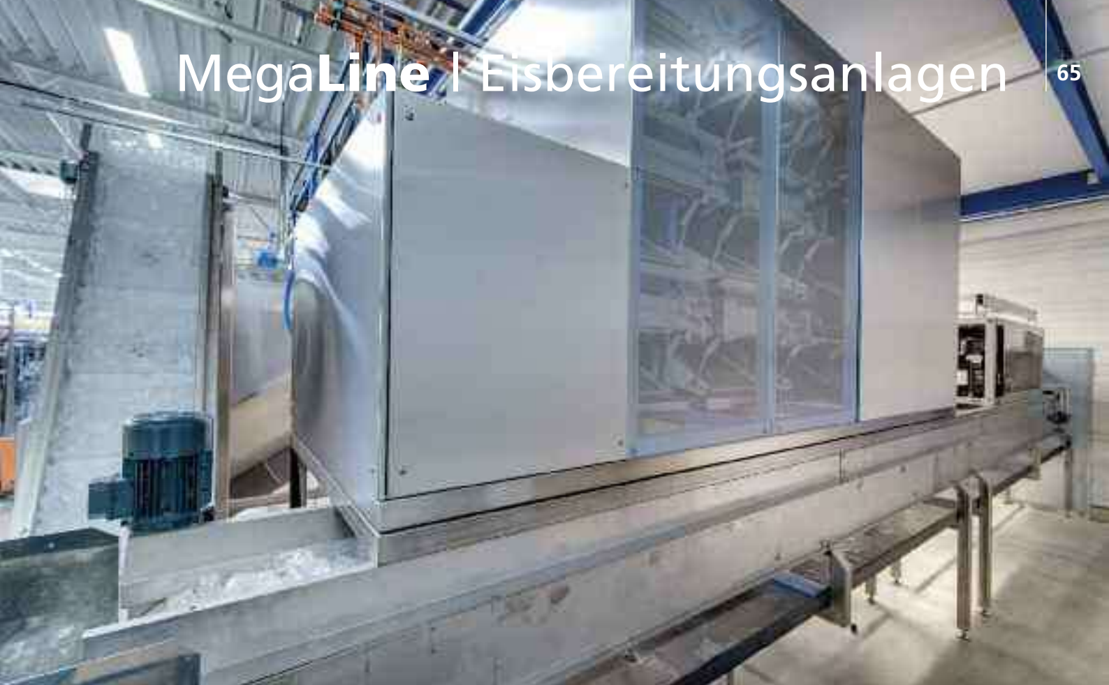
Hochleistungsfähige Eisbereitungsanlage IC 1500 mit Bandfördersystem und Abfülleinheit für quadratische Volleiswürfel
