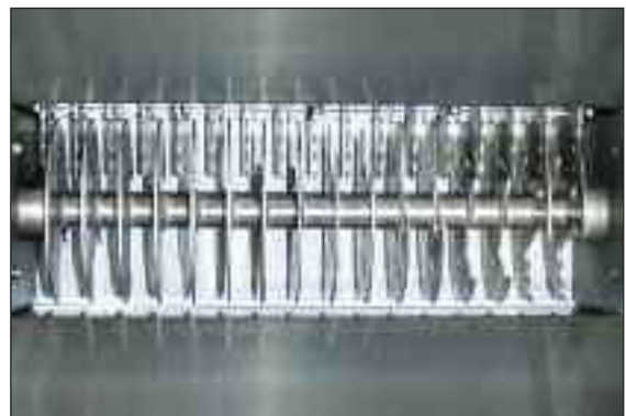
Mahlwerk des Crushermoduls aus solidem Edelstahl.
