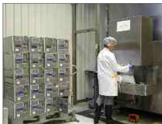
Eisproduktion mit halbautomatischer Abfüllung von Hohleis Kegeln für das Inflight-Catering
