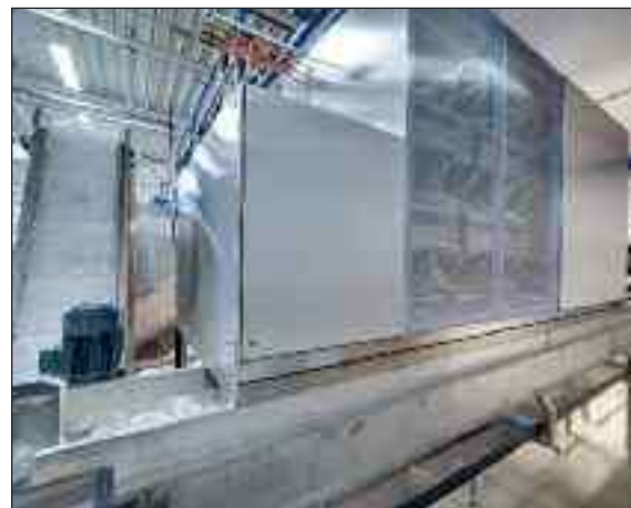
Eisbereitungsanlage IC 1500 auf Eistransportband zur Herstellung von quadratischen Volleiswürfeln
