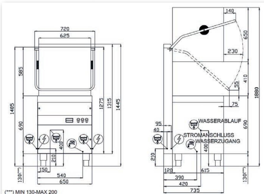
Das **Elektroanschluss-Kabel**, der **Abwasserschlauch** (Ø 24 mm) und die Schläuche für die **Reiniger- und Klarspüler-Zuführung** (Reiniger - weisser Schlauch ; Klarspüler - grüner Schlauch) werden am hinteren Ende seitlich aus der Maschine geführt.
