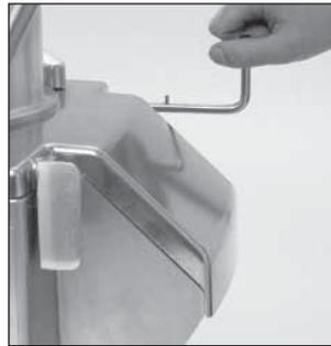
⑤ Führen Sie die Achse des Scharniers in das Gehäuse an der Rückseite des Motorblocks ein.
