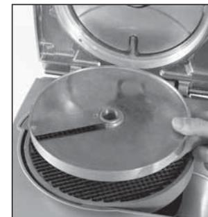
Anschließend die entsprechende Schneidescheibe einsetzen (Scheibe mit gerader Klinge) und diese im Uhrzeigersinn drehen, um sicherzugehen, dass sie richtig sitzt.
