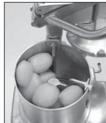
Für eine optimale Schnittqualität beim Schneiden von Pommes frites unbedingt die **herausnehmbare Trennwand** und nur den linken Teil der Einfüllöffnung benutzen (s. Abb.).
