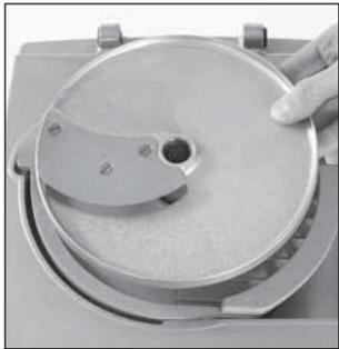
Anschließend die jeweilige Schneidscheibe darauf legen. Drehen Sie sie im Uhrzeigersinn zur Feststellung der korrekten Montage.
