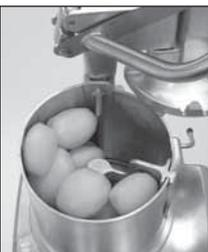
Für eine optimale Schnittqualität beim Schneiden von Pommes frites unbedingt die **herausnehmbare Trennwand** und nur den linken Teil der Einfüllöffnung benutzen (s. Abb.).
