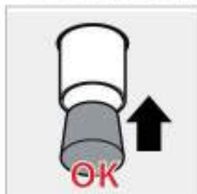
Wenn es nicht möglich ist, den Ofen BAKERTOP MIND.Maps™ dauerhaft an einen Ablass anzuschließen, muss das Anschluss mit dem kegelförmigen Stutzen des „Starter Kits“ verschlossen werden. Wenn Anschluss an den Ablass verstopft ist, dürfen die Waschprogramme NICHT verwendet werden bzw. es darf nicht mit großen Wassermengen gespült werden, da sonst Überschwemmungsgefahr besteht.
