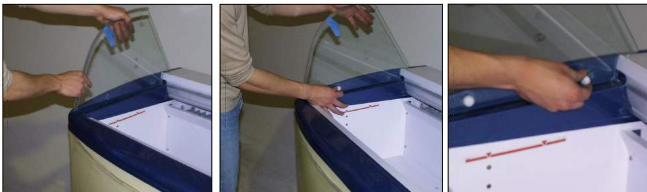
Montare i vetri laterali tramite le apposite viti.
