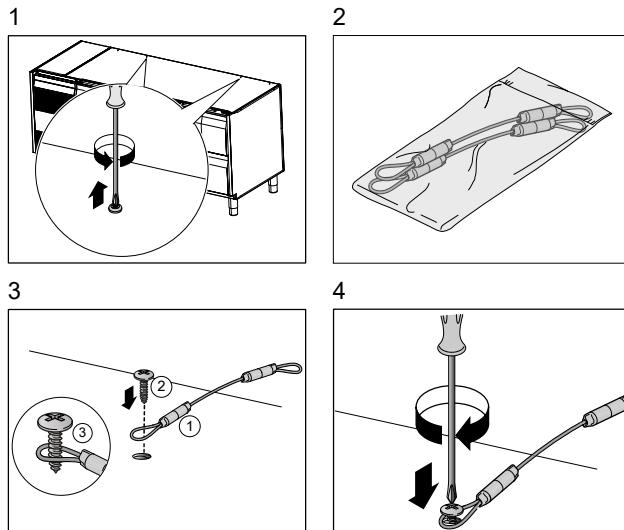
De kabel moet vervolgens met een plug aan de wand worden bevestigd om het apparaat permanent vast te zetten;
