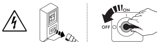
Trennen Sie das Gerät vor Installations-, Montage-, Reinigungs- und Wartungsarbeiten immer erst von der Stromversorgung.
