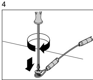
Fixieren Sie das Kabel anschließend mit einem Dübel an der Wand, um den sicheren Stand des Geräts zu gewährleisten.
