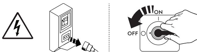
Alvorens willekeurig welke installatie-, montage-, reinigings- of onderhoudsprocedure uit te voeren, moet de elektrische voeding van het apparaat worden afgekoppeld.
