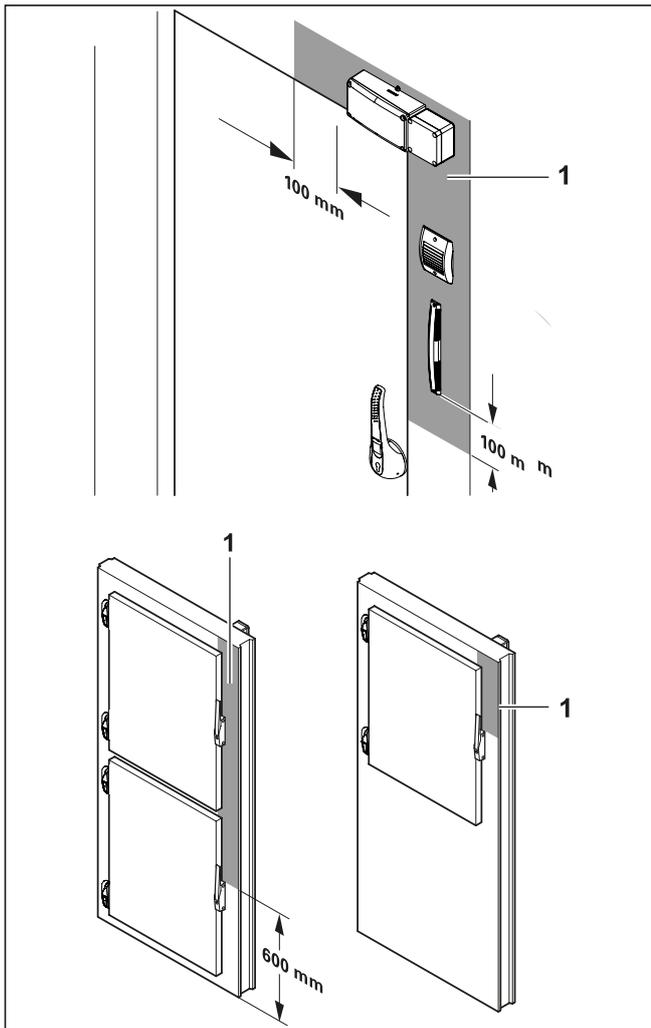
**ⓘ** Im grau markierten Sicherheitsbereich 1 sind elektrische Bauteile eingeschäumt. Beschädigungen der elektrischen Bauteile oder Leitungen besteht die Gefahr eines Stromschlags.
