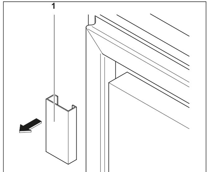
ⓘ Magnetdichtrahmen an Türen sind durch Sicherungsbleche vor mechanischer Beschädigung geschützt.
