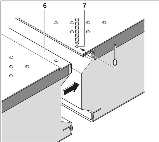
➔ Durch vorhandene Bohrung (7) in Blechoberfläche der Federseite Loch in Blechende des Gegenelements (6) bohren.
