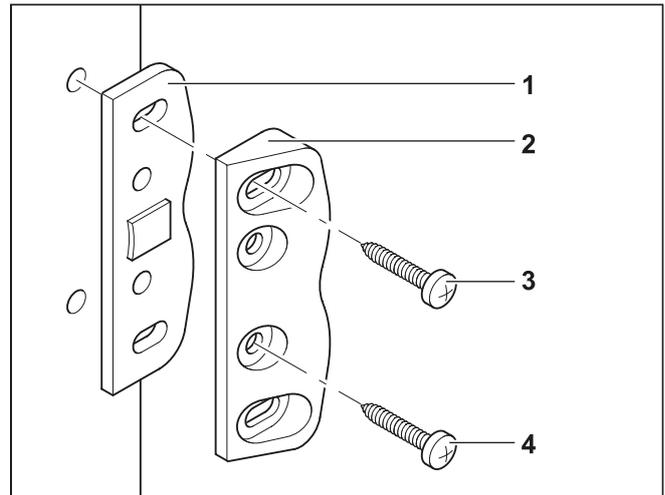
**i** Schließkeil des Drehheberverschlusses ist werkseitig angepasst.
