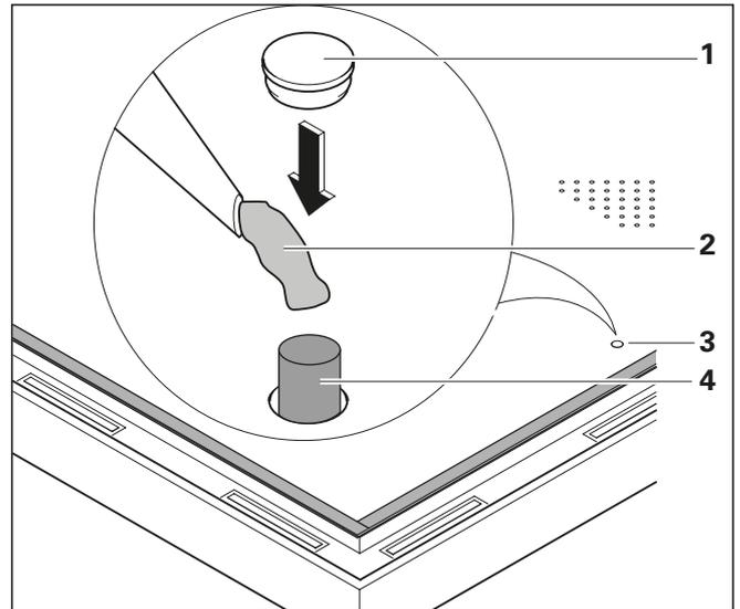
➔ Bedienöffnung (3) mit mitgeliefertem Wärmedämm-schaum-Füllstück (4) ausfüllen.
