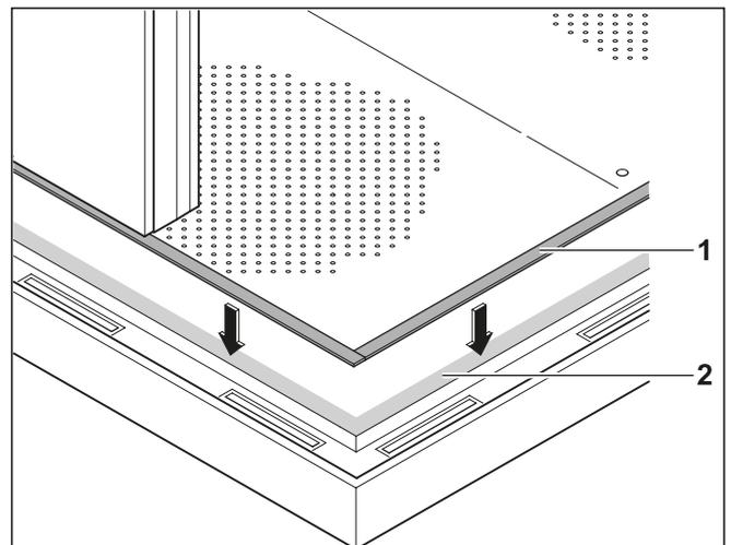
➔ Sicherstellen, dass Boden-Innenblech im Bereich des Wand-Innenblechs (2) fett- und staubfrei ist.
