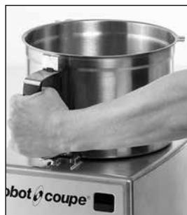
1) Stellen Sie sich vor den Motorblock und setzen Sie die Kutterschüssel auf den Motorblock.
