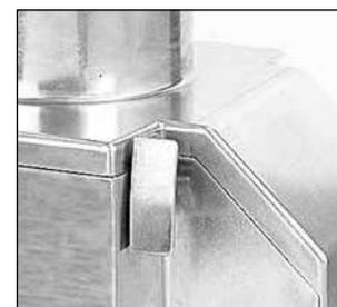
1) Stellen Sie sich vor den Motorblock und entriegeln Sie mit der rechten Hand den Aluminium-Feststellhaken, der zum Befestigen des Deckels am Motorblock dient.
