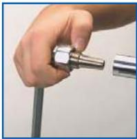
3: Die konisch verlaufende Innenschraube wird mit einem Inbusschlüssel in den Innenschlauch eingedreht. Gleichzeitig die Außenhülse mit einem Gabelschlüssel gehalten.
