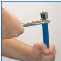
1: Die Hülse zunächst mit der größeren Öffnung aufsetzen und locker aufschrauben. Dabei dreht sich das Innengewinde der Hülse auf die Außenhülle des Schlauches.
