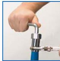
4: Dabei dreht sich das Gewinde der Schraube in den Innenschlauch und verquetscht den Schlauch wasserdicht zwischen Außenhülse und Innenschraube.
