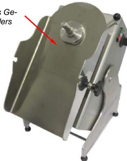
**Abb. 19: Gehäuse des Gemüseschneiders auf Antriebseinheit aufgesteckt**
