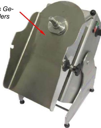
**Abb. 34: Gehäuse des Gemüseschneiders auf Antriebseinheit aufgesteckt**
