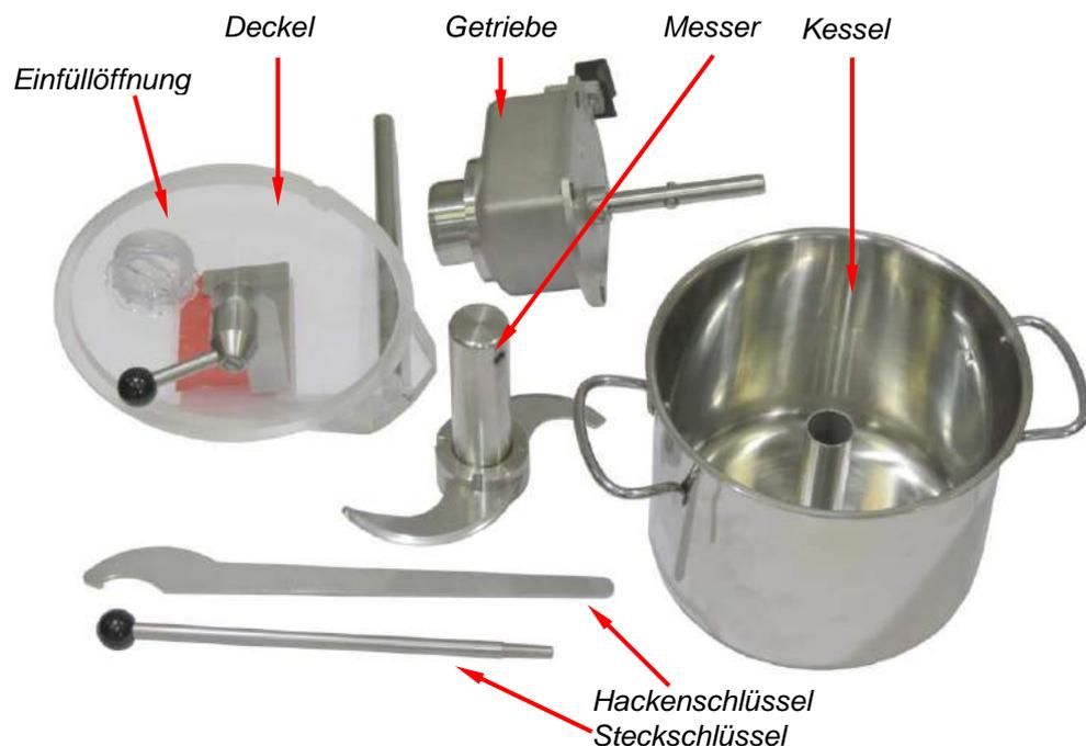
**Abb. 64: Aufbau des Cutters**
