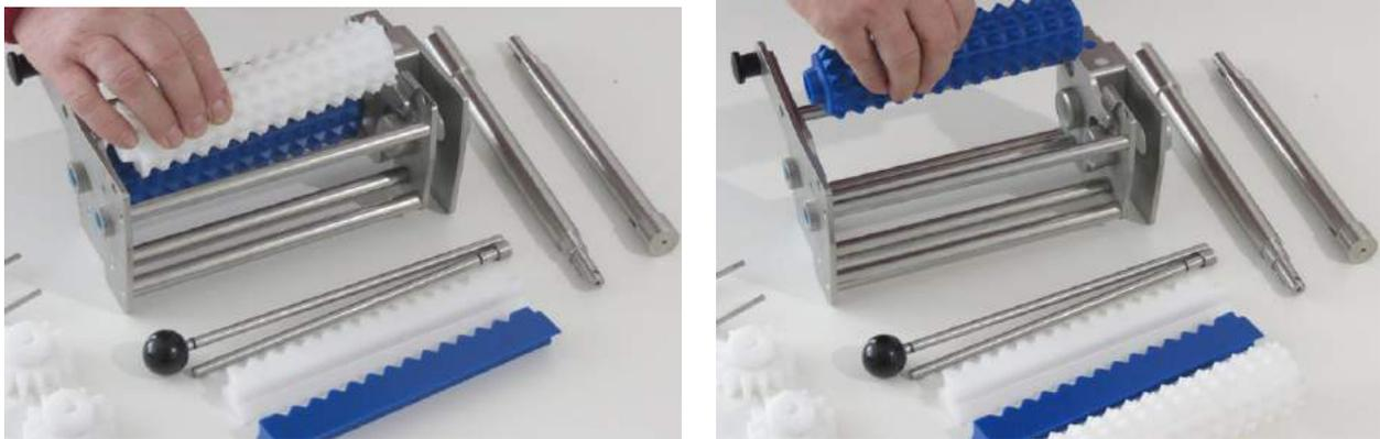
Abb. 95: Mürbewalze B (links) und A (rechts) entnehmen
