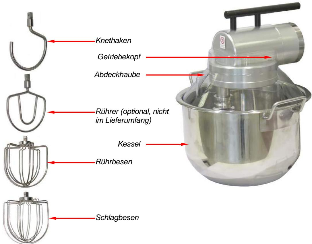
Abb. 51: Planeten-, Rühr-, Schlag- und Knetwerk UP 15
