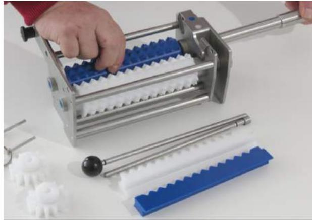
**Abb. 97: Montieren der Mürbewelle A**
