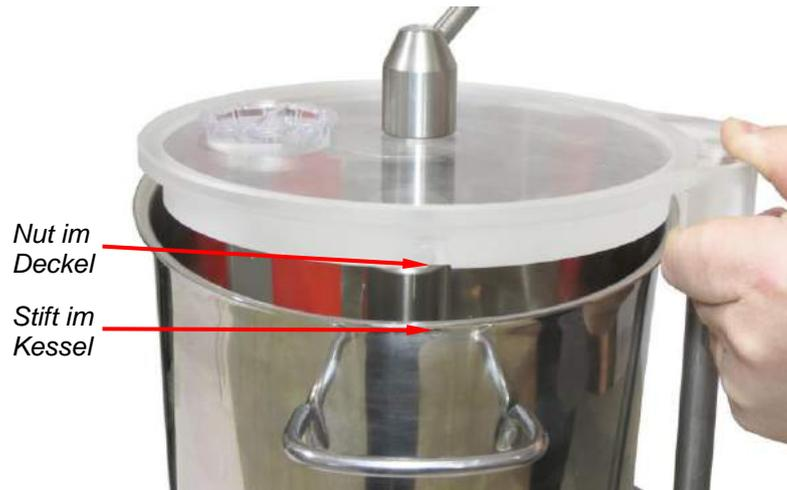
Abb. 66: Deckel aufsetzen
