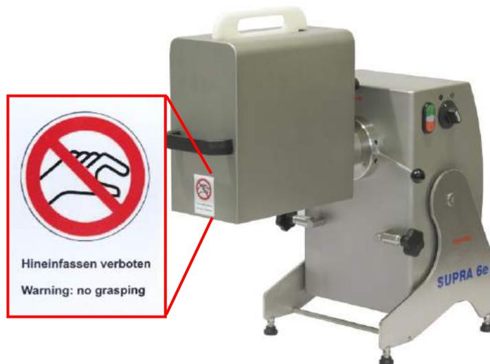
Abb. 4: Gefahrenhinweise an den Trichterhauben der Walzenaufsätze
