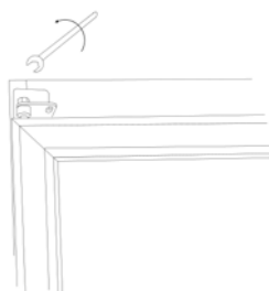
8. Den Stift vom oberen Scharnier spannen.
