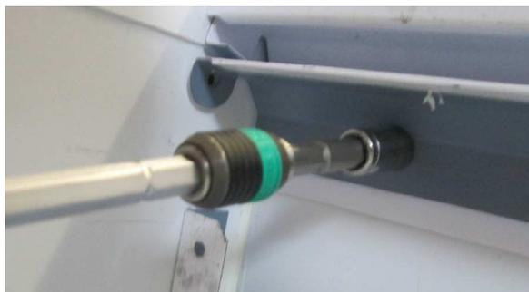
Zu erst die Blechschraube an der Seitenwand mit einem Kreuzschlitz-Schraubendreher lösen. Anschließend die einzelnen selbstsichernden Muttern (SW 8) etwas lösen, nicht ganz abschrauben.
