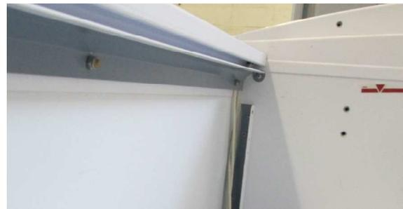
Unter der Blechschiene mit der Gummidichtung befindet sich eine zweite Winkelschiene.
