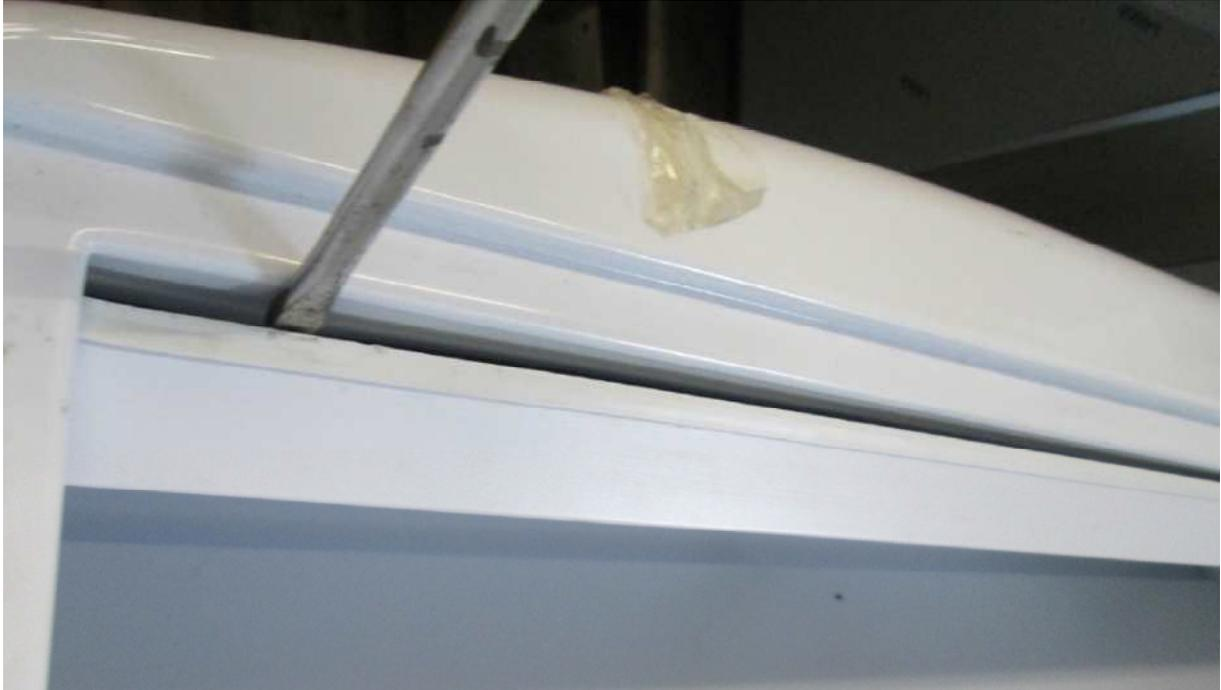
Jetzt kann die Metallschiene mit der Gummidichtung nach hinten gebogen werden. Die Prallscheibe kann jetzt problemlos in die Nut eingesteckt werden.
