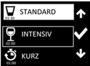
Aktuelle Einstellungen sind durch inverse Darstellung gekennzeichnet. Die Displaytasten dienen kontextabhängig zur Navigation oder Auswahl und sind mit entsprechenden Symbolen gekennzeichnet. Beispielsweise Wählen der gewünschten Auswahl durch Auf/Ab-Pfeilsymbol oder durch Links/Rechts-Pfeilsymbol bzw. Einstellen durch +/- Symbol. Eine von der aktuellen Einstellung abweichende Auswahl wird durch einen Rahmen gekennzeichnet. Bestätigung der Auswahl durch Antippen des Haken-Symbols.
