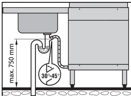
Die Verbindung zwischen Maschine und bauseitigem Ablauf darf die maximale Höhe von 0,75 m nicht übersteigen.
