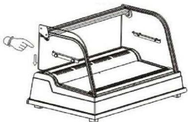
5. Setzen Sie die linke Glasscheibe in die rechte Glasfassung am Gehäuse des Gerätes ein.
