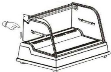
5. Insérer la vitre latérale de gauche dans la fente de gauche du corps de l'appareil.
