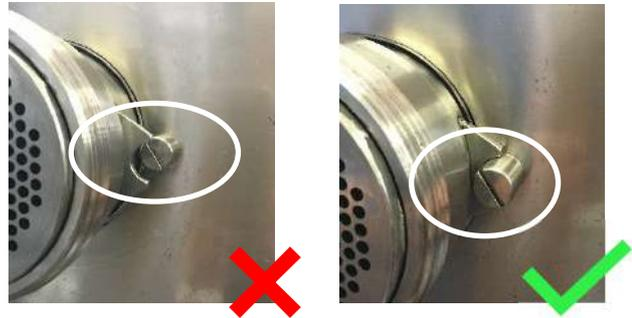
Die Einführung der Schneckenwelle (15+16) erfolgt in der Form, dass die Welle mit dem Antriebszapfen zuerst in das Schneckengehäuse eingeführt wird. Sie wird nach hinten durchgeschoben und die Schneckenwelle so lange gedreht, bis sie mit ihrem Antriebszapfen am hinteren Ende in das gleichförmige Langloch des Antriebes einrastet.
