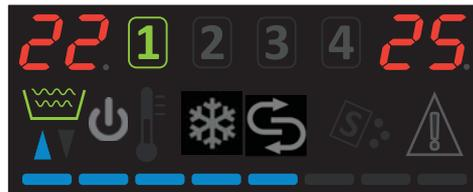
Anschließend, wenn der Tank gefüllt ist, leuchtet die START-Taste **E** auf, und die Heizphase beginnt. Bei Maschinen, die mit dem WRAS-zertifizierten Break Tank System ausgerüstet sind, ist die Dauer der Tankfüllung verlängert. Wenn die Tank- und Boilertemperatur erreicht wurde leuchtet die Leuchtanzeige **S** auf (siehe Kap. 2). Auf den Anzeigefeldern **F** und **M** wird die jeweilige Tank- und Boilertemperatur eingeblendet.
